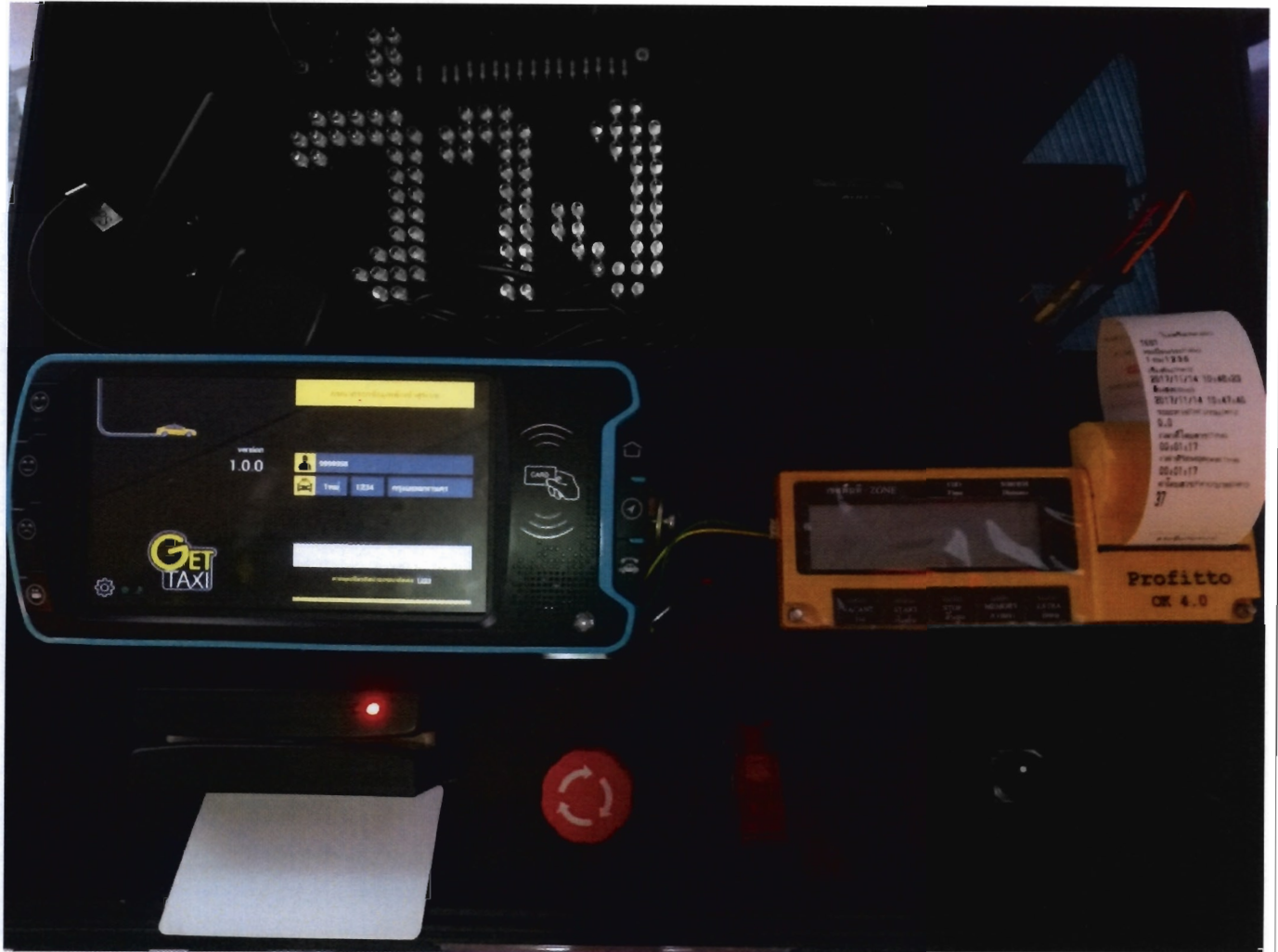
เครื่องบันทึกข้อมูลการเดินทางของรถ ชนิด DISTAR แบบ TXM-3GM2C เมื่อเชื่อมต่อกับอุปกรณ์บ่งชี้ผู้ขับรถ ชนิด Distar แบบ MGNR-N1 และอุปกรณ์อื่นที่เกี่ยวข้อง
